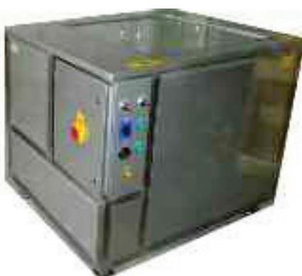
Odmastovanie, čistenie a umývanie mechanických súčiastok v ultrazvukových vaniach.
